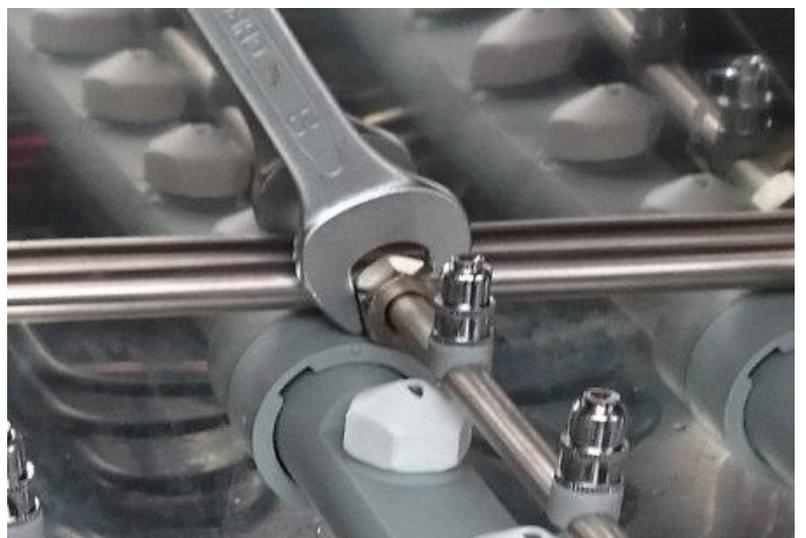
Nachdem die Nachspüldüsen eingestellt sind, montieren Sie den oberen Nachspülarm wieder in die Maschine.
