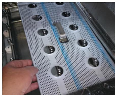
Entnehmen Sie den Ansaugfilter und ggf. reinigen Sie diesen wenn erforderlich. Wascharme mit einer leichten Links-Drehung und leichtem Ziehen aus der Bajonethalterung entnehmen.
