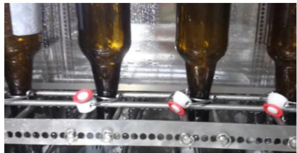
Sollte einer oder mehrere Nachspülarme nicht in die Flaschenöffnung spritzen, nehmen Sie einen Gabelschlüssel (Maulweite 20), lockern Sie die Mutter des Nachspülarmes und drehen diesen in die korrekte Position. Der Nachspülarm kann seitlich (links und rechts) gedreht sowie herausgezogen oder hineingeschoben werden.
