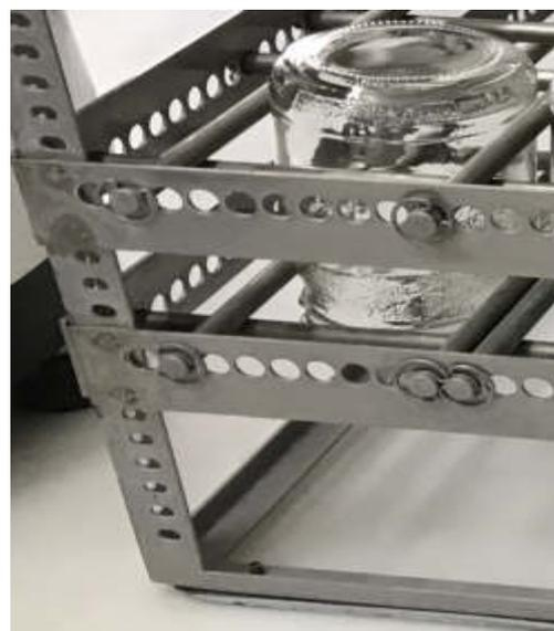
Für Flaschen die nicht aus Glas sind – daher ein geringes Eigengewicht haben – ist es erforderlich, dass die Führungsstangen die Flaschen (z.B. aus Kunststoff) festhalten. Hierfür sind die Führungsstangen so zu montieren, dass die Flaschen in der erforderlichen Position gehalten werden.
