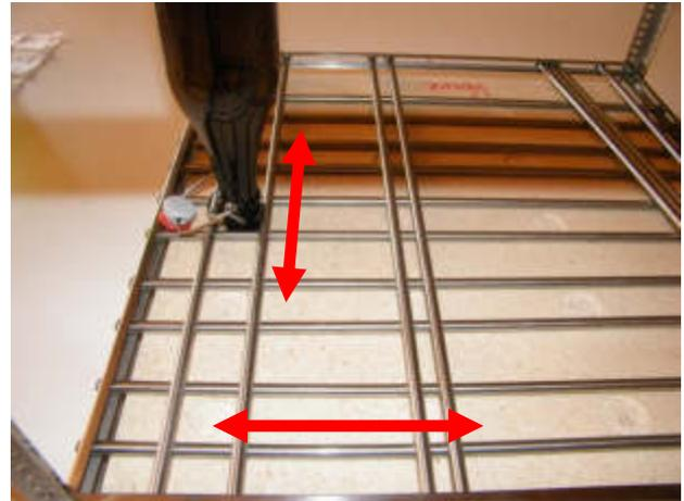
Bei Milchflaschen kann es aufgrund des Flaschen Durchmessers vorkommen, dass die Führungsstangen (von links und rechts) nicht benötigt werden, um 20 Flaschen in den Korb zu stellen. Daher die Querstangen in diesem Fall nicht montieren.
