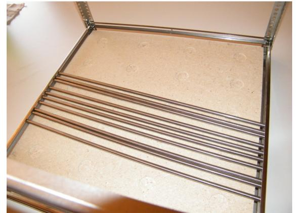
Prendete la vite con la relativa rondella e fissate le barre di supporto. Serrate le viti solo leggermente in modo che le barre di supporto possano ancora essere spostate.
