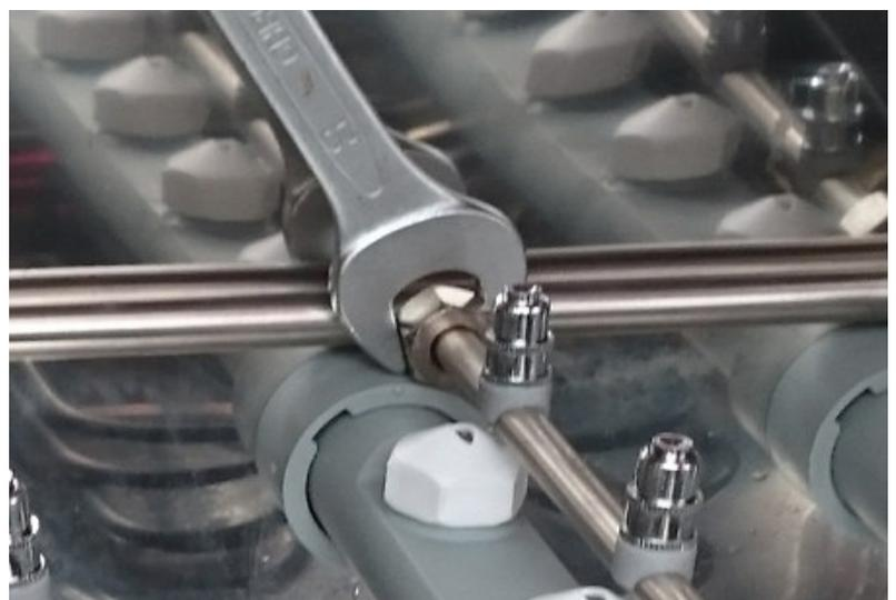
Dopo che gli ugelli di risciacquo sono stati regolati, montate nuovamente il braccio di risciacquo superiore nella macchina.
