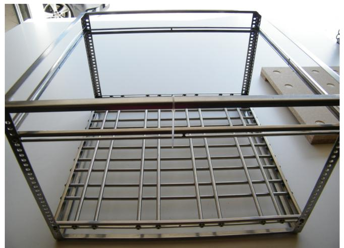
Come per il livello inferiore, montate prima i listelli di supporto.
