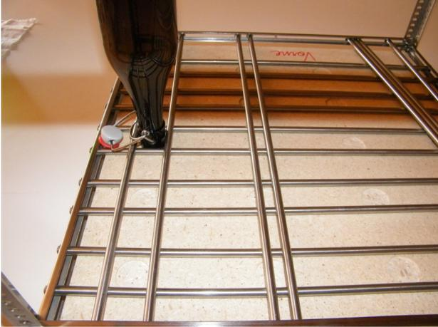
Controllate sempre che la posizione della bocca della bottiglia coincida esattamente con l'incavo della maschera di misurazione.
