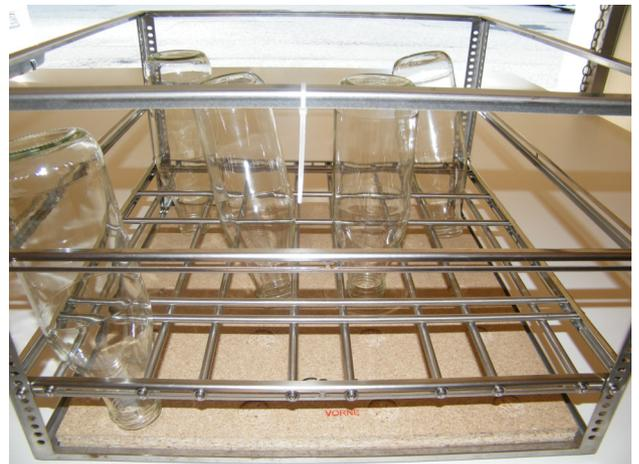
Die Schrauben an den Trägerstangen nur leicht festziehen, sodass eine exakte Positionierung der Flaschen möglich ist.
