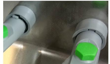
Wascharm aus der Halterung klippen und aus der hinteren Aufnahme herausziehen.
