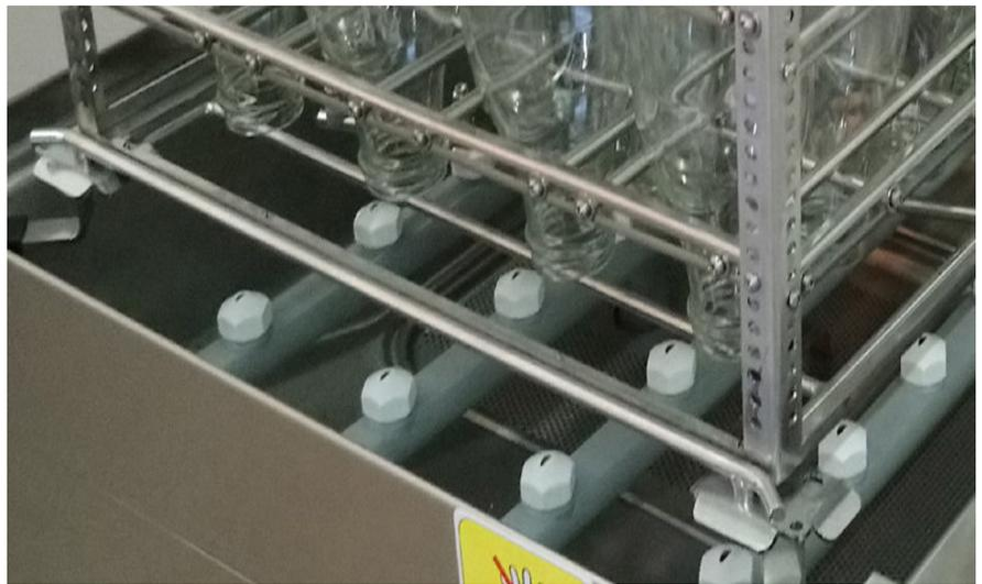
Schließen Sie die Haube und der Waschvorgang (4 min. und 50 sec.) beginnt. Die Kontrolllampe (Nr. 3) leuchtet. Nach Beendigung des Waschvorganges erlischt die Kontrolllampe (Nr. 3). Öffnen Sie die Haube und entnehmen Sie den jeweiligen Korb mit dem Spülgut.
